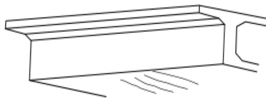
图2 底板横向裂缝
