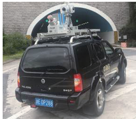
图1 车载移动测量系统硬件组成
