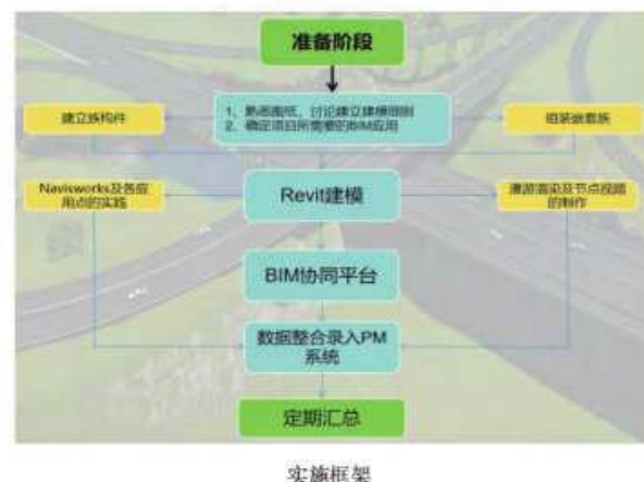
图 3-1 : BIM 整体实施方案流程和框架
