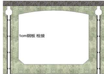
顶板浇筑10cm混凝土
