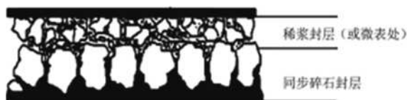
图1 公路路面新型开普封层结构设计
