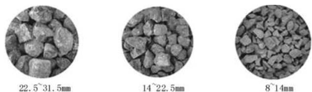
图2 碎石、砂石材料粒径划分
