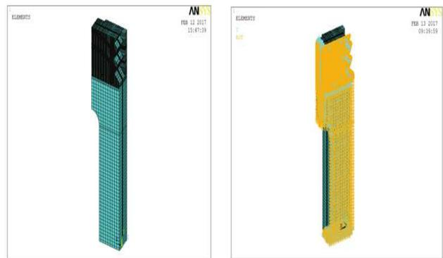
(a) 索塔 1/4 模型 (整体) (b) 模型整体边界条件
