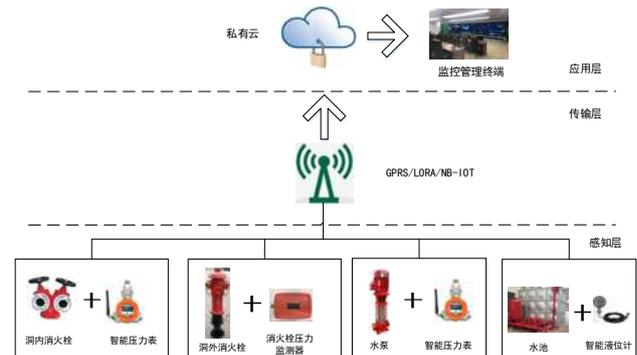
图1 智慧消防管理系统架构图
