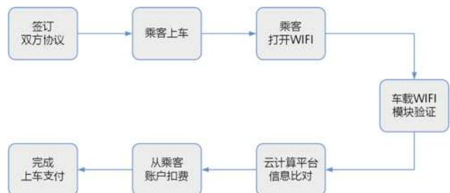
图3 WIFI探针无感支付流程图
