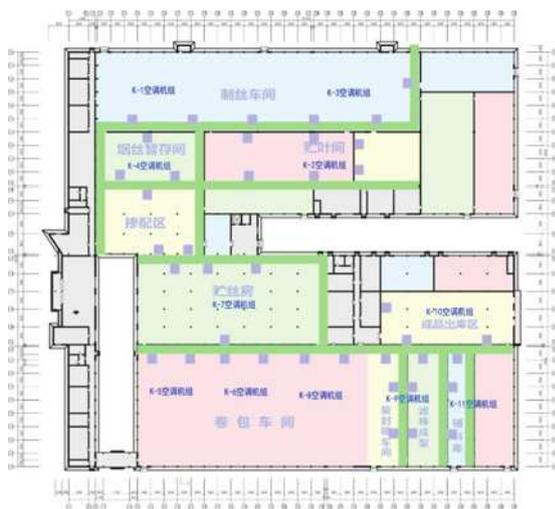
图3 空调区域风压测量点分布图
