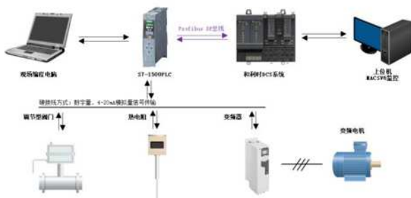
图1 S7-1500PLC与和利时DCS通过PROFIBUS-DP通信系统结构示意图
