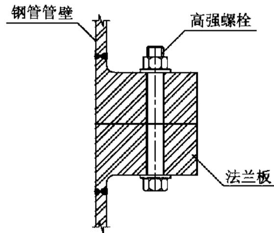
图 2 螺栓连接技术
