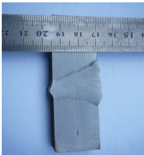
图3 宏观焊接缺陷检查
