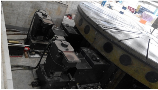
图5 重型数控立式铣车复合加工中心 双电机驱动C轴分度装置
