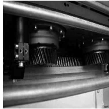
图6 重型数控卧式机床Z轴驱动装置
