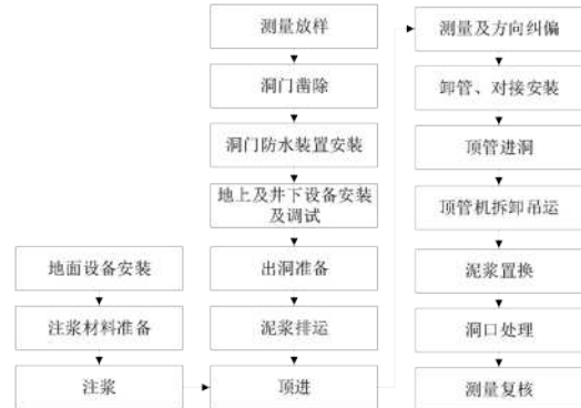
图5 顶管施工工艺流程图
