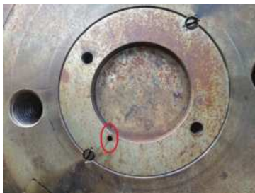
图5 汽轮机转子电侧对轮中心孔堵板上的小孔
