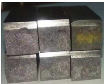
图4 3-1#冲击试样断后形貌
