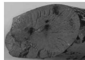
图2 吊杆断口的宏观形貌
