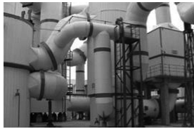
图1 某压力容器和压力管道的具体链接
