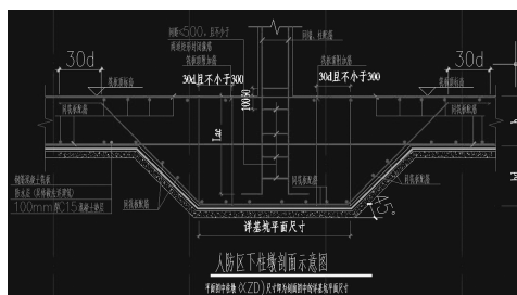
图 2 人防区下柱墩剖面示意图
