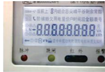
图3 (b)不合格液晶屏检验结果
