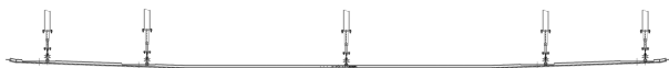
车辆段储能式现代有轨电车用架空充电轨系统的结构示意图
