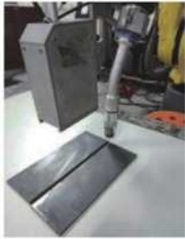
a) 被动视觉焊接导引
