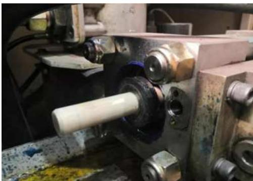
图 2 高压水加压部件陶瓷活塞杆
