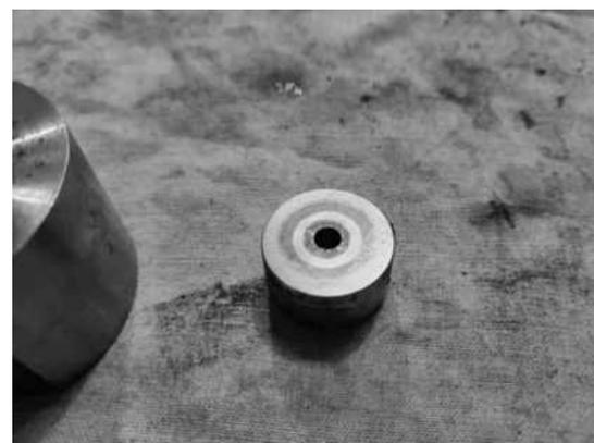
图 4 磨损的出口阀座
