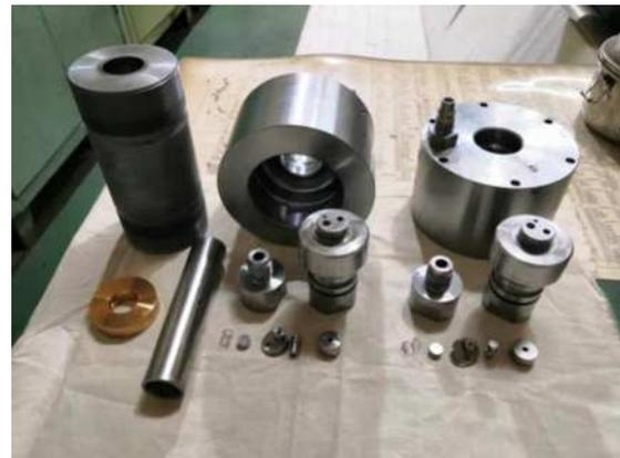
图 8 清洗干净所有拆卸零件
