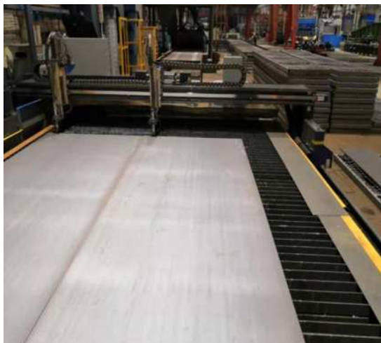
图 1 同时切割两张预处理完成的大型板材
