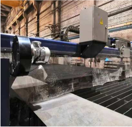
图 4 在机床后面加装防火帘也为提高密闭性
