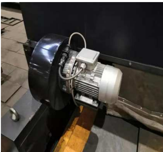
图 5 机床边缘加装侧吹风风机
