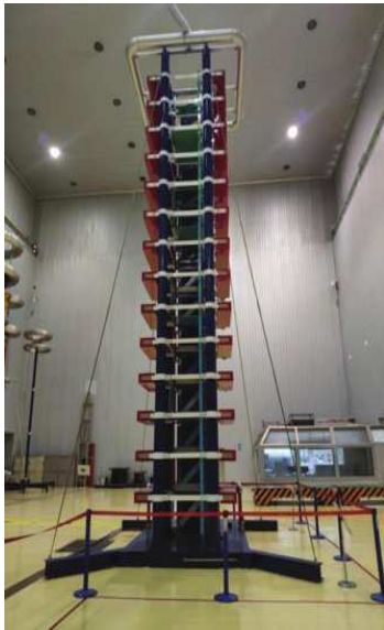
图5 2800kV 雷电冲击电压发生器
