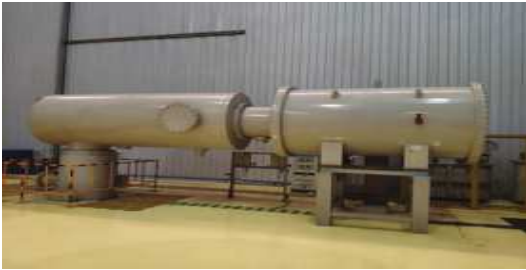
图6 1000kV/4A 六氟化硫气体绝缘试验变压器
