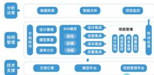
图 1 基于 BIM 技术工程造价管理
