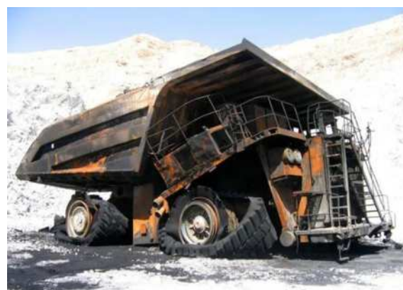
图1 矿用自卸车烧毁
