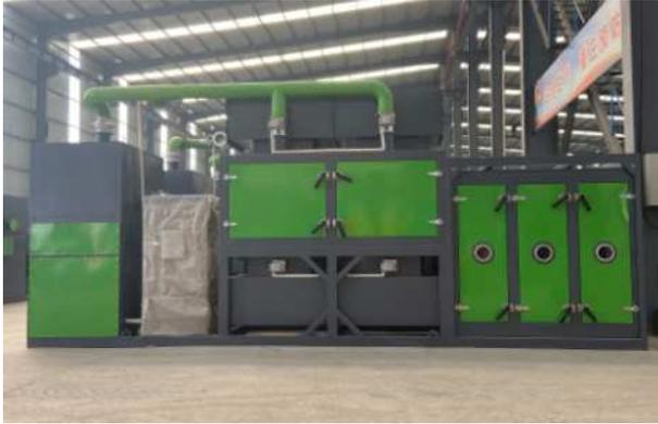
图 1 喷涂废气燃烧处理设备
