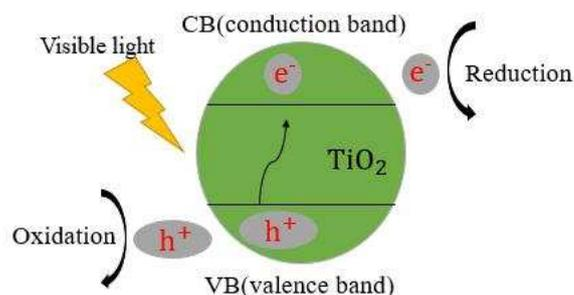
图 1  $\text{TiO}_2$  光催化机理
