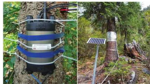
图1 径流仪及太阳能供电系统
