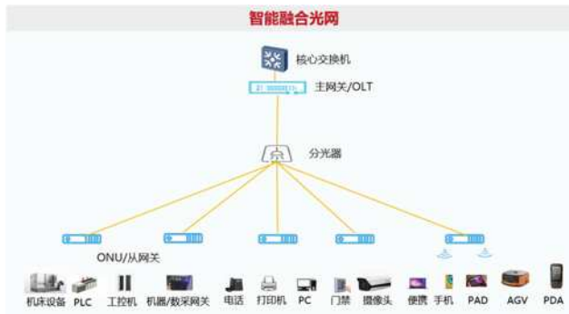
图2 智能融合光网支持一纤多业务接入网络结构图
