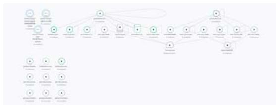
Istio 的 Ingress gateway 是外部流量的唯一入口，它将外部的请求分别路由到不同的微服务。同时，所有集群容器的遥测 (Telemetry) 数据被收集，其中包括应用、数据库以及 Istio 组件的所有信息。
