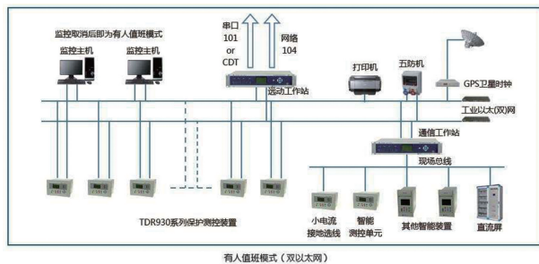
图2 变电站综合自动化系统解决方案
