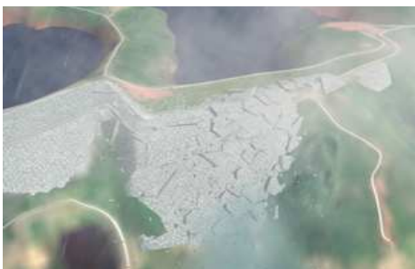
图4 尾矿库开裂模拟
