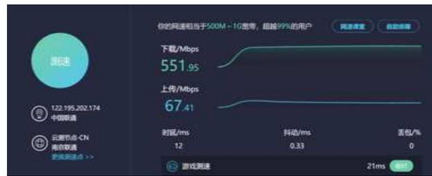
PC终端测试，采用不同性能的网关作为测试对象，其中一个网卡型号为AC3168，非千兆网卡，测速为209.91Mbps；一个网卡型号为AC9560千兆网卡，测速为551.95Mbps。
