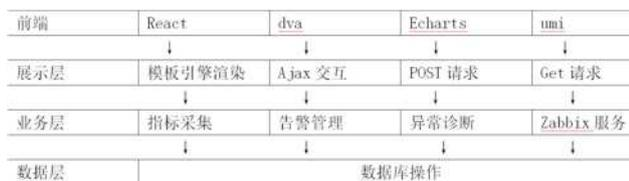
图2 基于Zabbix的云监控系统逻辑架构图
