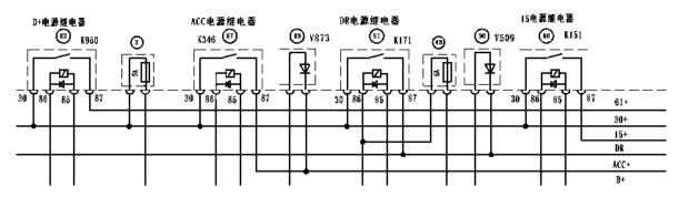
接线柱上的30电为各个继电器的输入电,而继电器的86端为其控制端,D+电源继电器输出61电,ACC电源继电器输出ACC+电,DR电源继电器输出DR电,15电源继电器输出15电。这些电为特定的用电单元提供电源,使其工作。继电器上的输出电经过保险分配到各个插接器的线束上,由线束连接用电单元(组合开关、显示屏、组合仪表、控制器等)。
