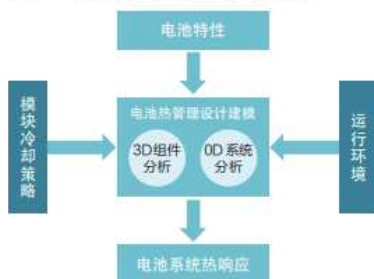
图1 电池热管理系统的设计流程
