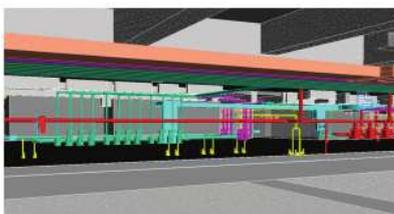
图6 地下室综合管线较集中的布置处横向三维图 2
