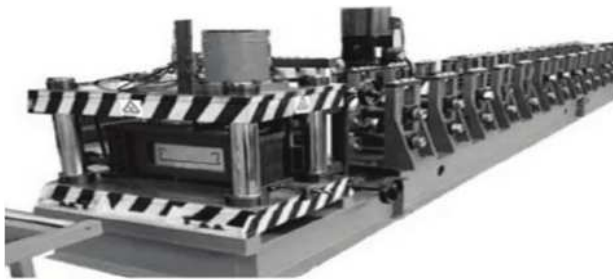
图5 自动脚踏板型材全自动生产线设备
