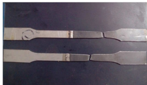
图 6. 试样显示 CS 侧远离焊缝和 HAZ 的故障。
