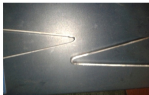
图 7. 显示符合要求的焊接财产的试样。
