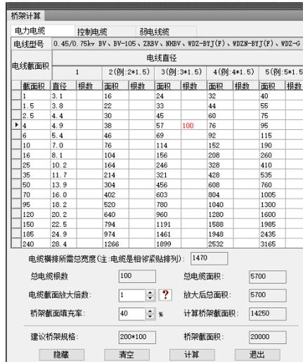
天正电气桥架计算示意图
