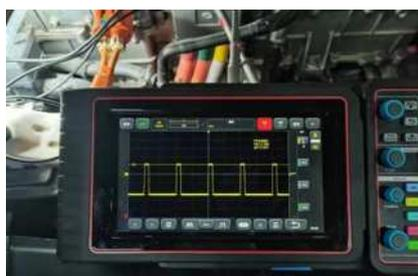
图 3 交流充电 CP 端子实测波形
