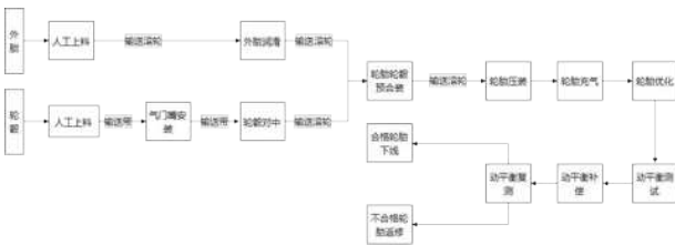
图 1 轮胎分装工艺布局图
