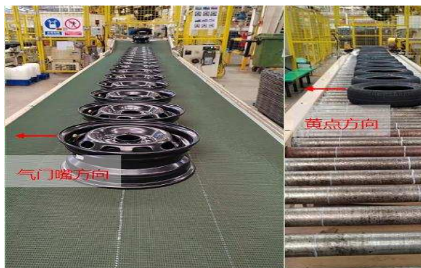
图 6 外胎、轮毂输送线对齐参照线
