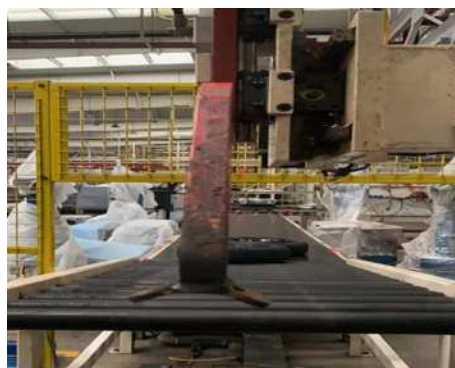
图 8 装胎压头焊接压块
