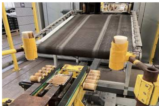
图 9 抱夹头表面粘贴摩擦片
