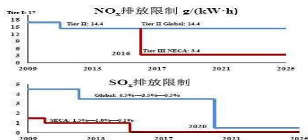
图 1 NO<sub>x</sub> 和 SO<sub>x</sub> 的排放限制
