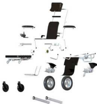
图6 轮椅零件爆炸图
