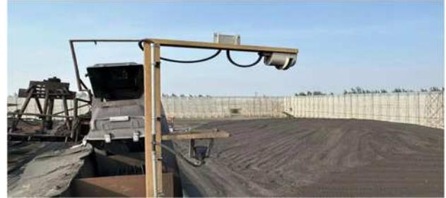
图 1 煤堆激光扫描装置
