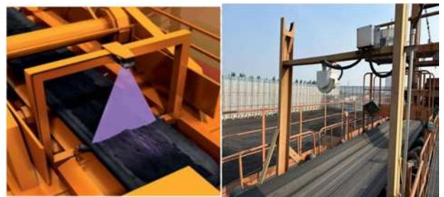
图 3 煤流检测装置及安装示意图
