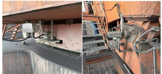
图6 斗轮机悬臂回转、俯仰编码器
