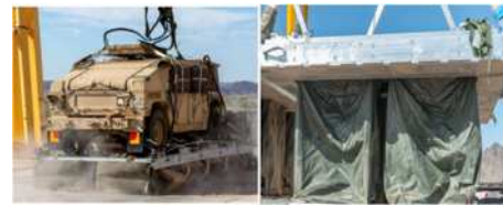
图 2-4 快速拆装索具空投系统的缓冲气囊
