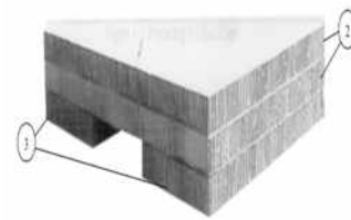
图 2-3 TRIAD 纸箱空投系统底部蜂窝纸板
