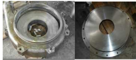
图五 油浆泵衬里修复后照片
