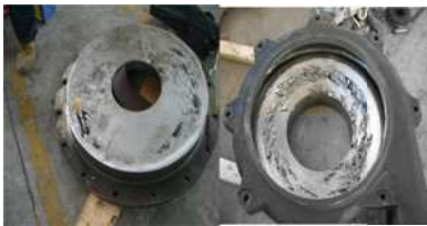
图二、油浆泵衬里典型磨蚀照片
