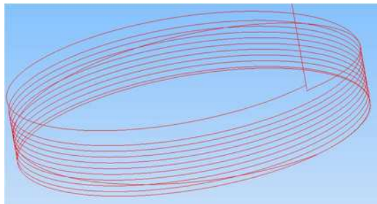
图 5 螺旋插补指令应用二加工路径
