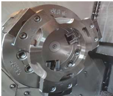
图6 常规三爪装夹零件
