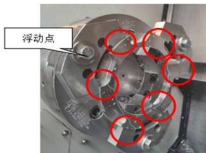
图7 浮动三爪装夹零件
